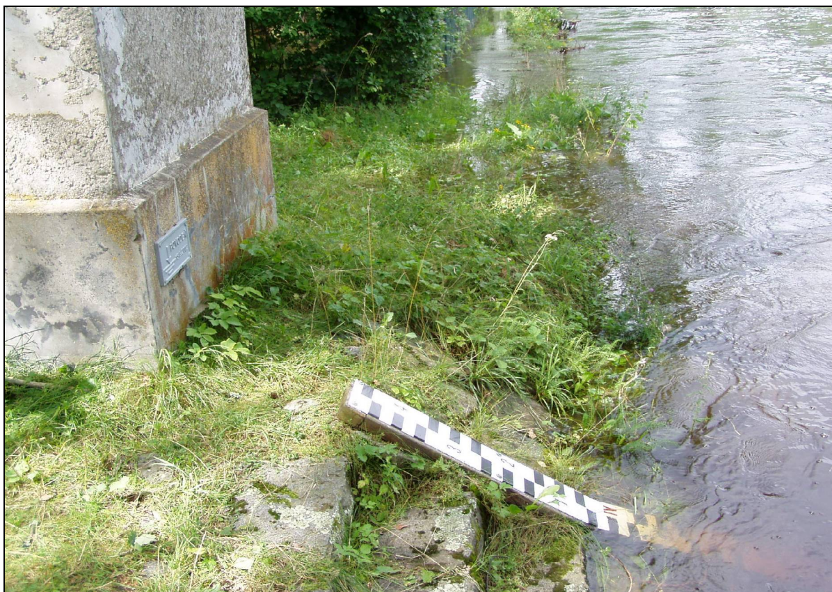
Obr. č.2 Vodočetná lať a limnigraf v Pilaři
